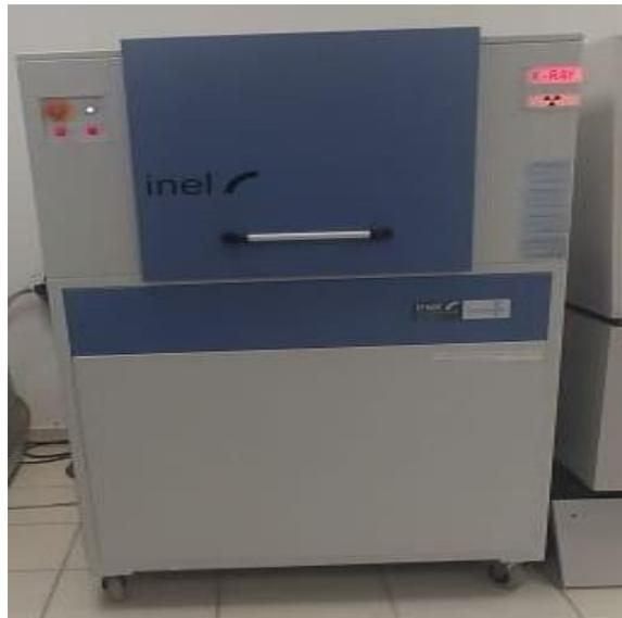
*Figura 4.9.-Difractómetro de Rayos X Equinox 2000.*
