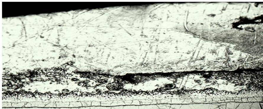
*Figura 5.11.-Lámina con exceso de Zn*
