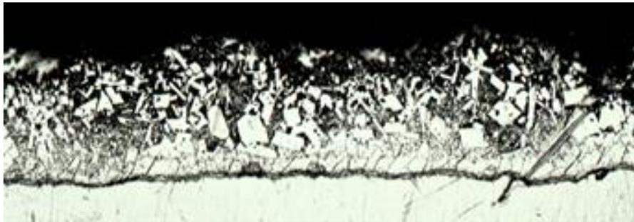
*Figura 5.10.-Lámina con ausencia de capa eta.*
