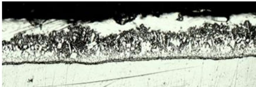
*Figura 5.9.-Lámina galvanizada*
