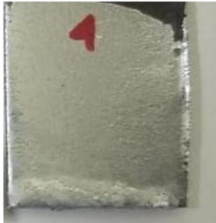
*Figura 5.3.-Lámina galvanizada*
