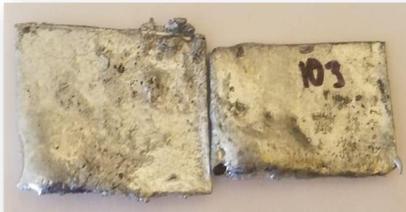
*Figura 5.5.-Láminas con exceso de Zn.*
